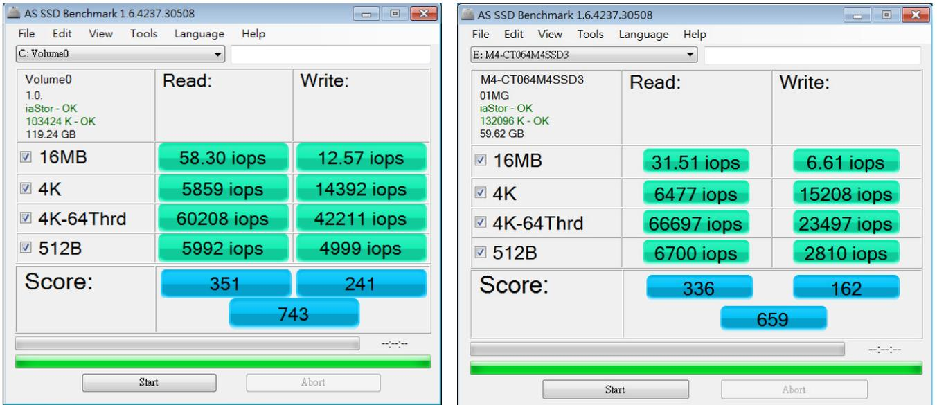
左圖表示二支 mSATA SSD, 設成 RAID 0, 使用 AD963DB9 轉接卡測試效能
