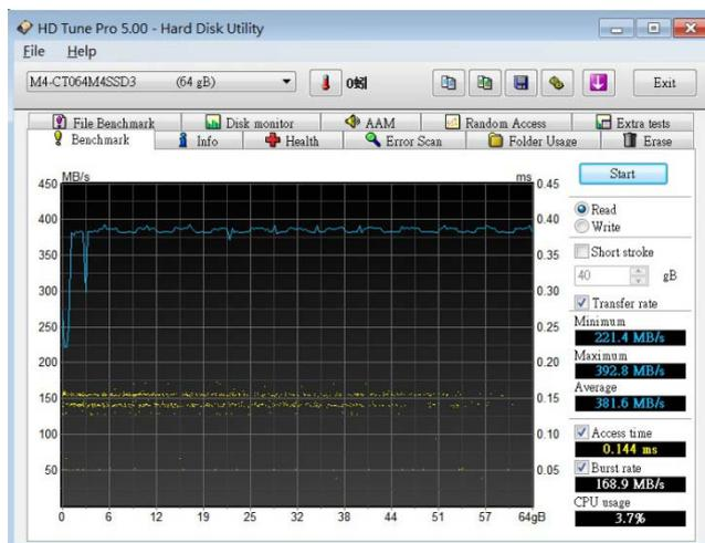
左圖表示二支 mSATA SSD, 設成 RAID 0, 使用 AD963DB9 轉接卡測試效能
