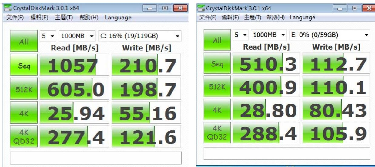
左圖表示二支 mSATA SSD, 設成 RAID 0, 使用 AD963DB9 轉接卡測試效能
